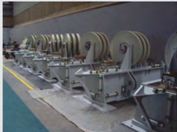
Poutres de fondation fabriquées selon la conception de Rexroth-Bosch, Pays-Bas pour le chantier naval de Goa.
