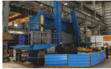
VTL pour l'usinage jusqu'à 6300 mm OD et 3500 mm de hauteur.
