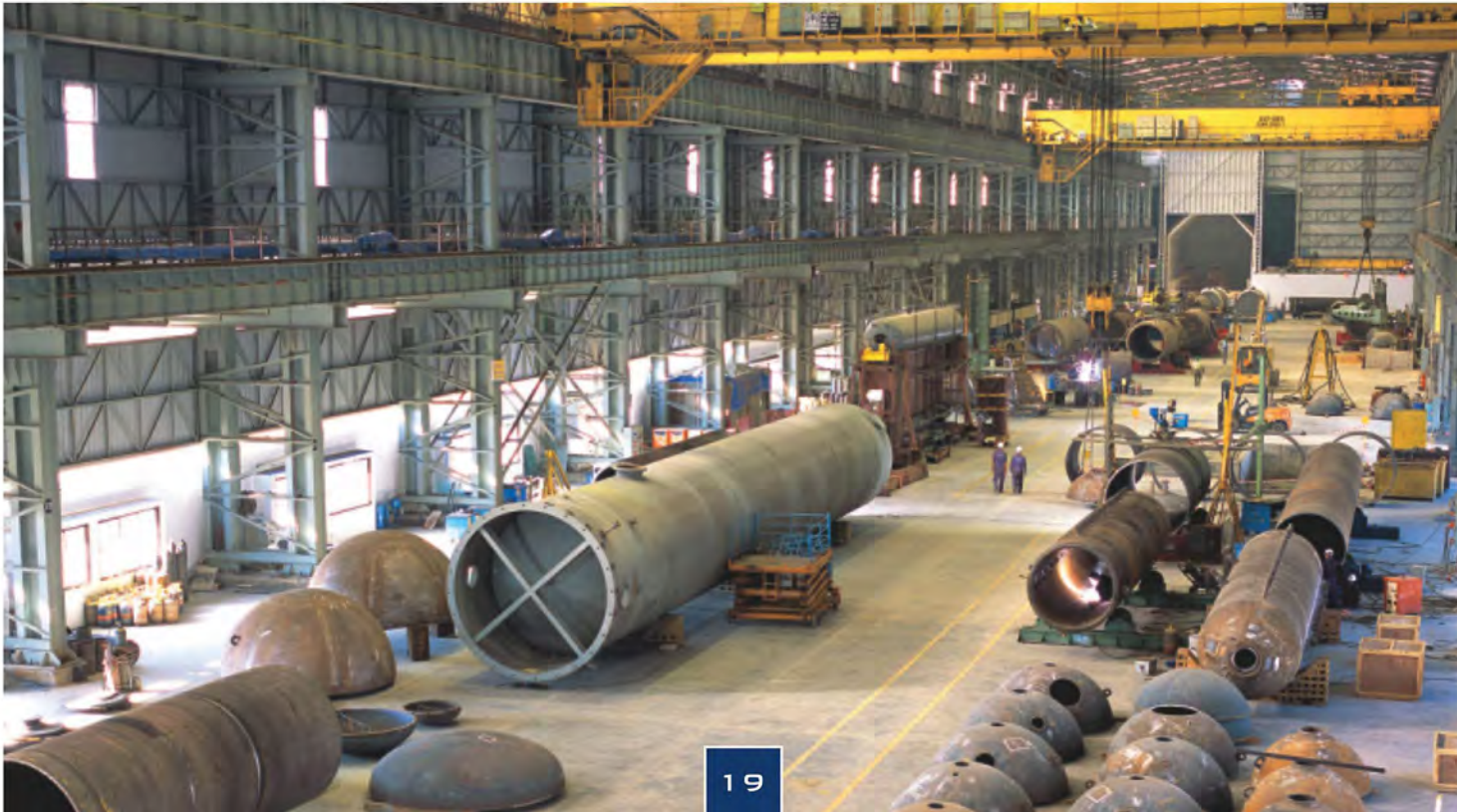
Atelier lourd à Dahej avec une grue dont la capacité de levage est de 300 tonnes et une hauteur sous crochet de 14 M.
