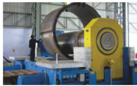
Haeusler Bend Roll avec une capacité de laminage à froid d'une épaisseur de 250 mm.
