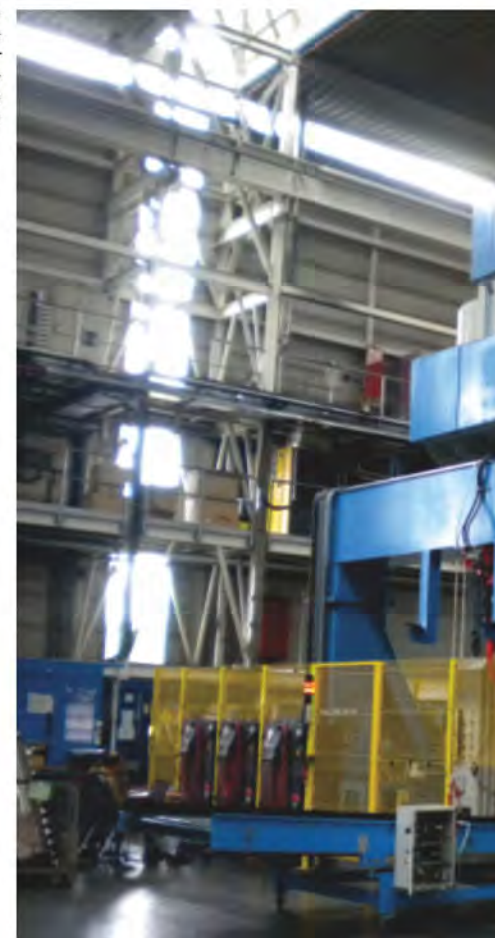
>>> Presse de transfert de 2000 tonnes fournie à Brandl, Allemagne avec une grandeur de table de 6100 mm x 2800 mm et 5 stations de transfert automatisées avec une étampe à coussin de 64 tonnes à chaque station
