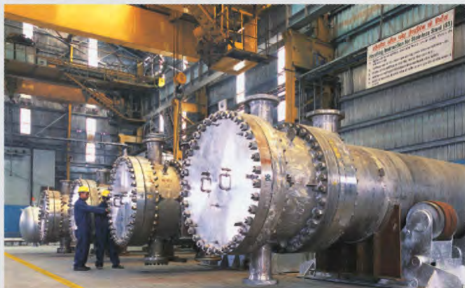
Les échangeurs SS fournis à Lurgi, Allemagne pour la centrale de production d'hydrogène au PAYS-BAS.
