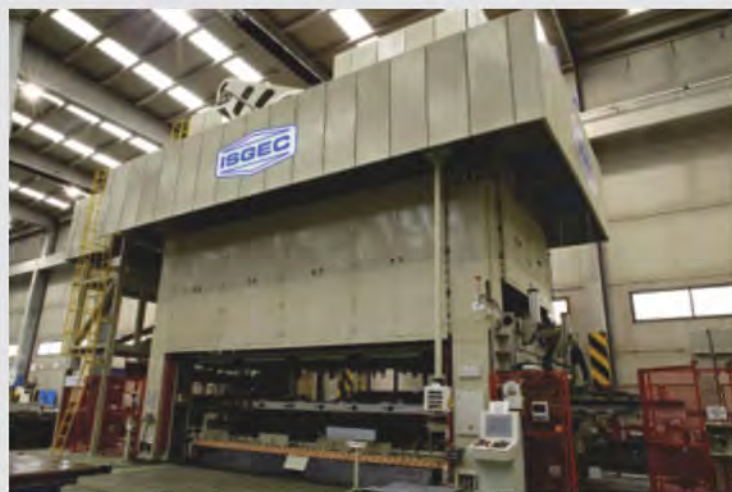
<<< Presse de transfert de 2500 tonnes Fournie à CIE Automotive, Espagne avec grandeur de la table de 7000 mm x 2800 mm et équipé de 3 axes Système de transfert électronique avec circuit d'alimentation.
