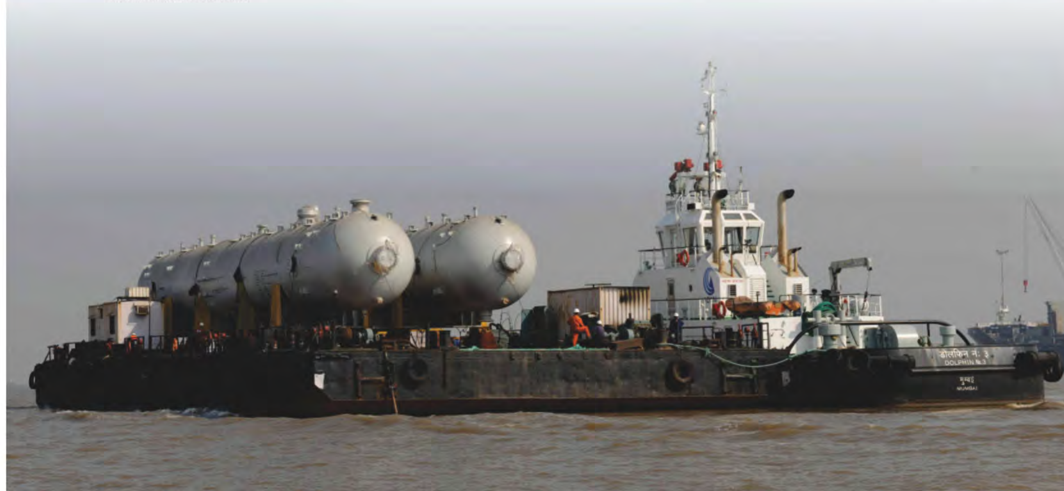
Fours à coke fournis à MRPL pour leur établissement DCU par Punj Lloyd. 4 types de tels fours à coke plaqués ont été fournis ayant un diamètre de 9144 mm, une longueur de 41 600 mm et pesant 454 tonnes chacun.
