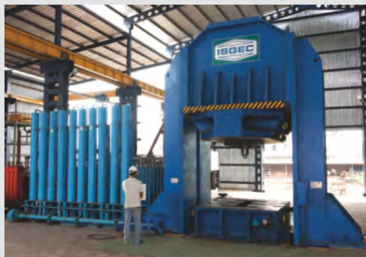
<<< Presse hydraulique de 12500 tonnes avec une Banque d'accumulateur est en cours d'utilisation pour le formage à chaud et à froid de plaques de tôle d'acier de grande résistance à la traction pour les industries de la défense et de l'aérospatial
