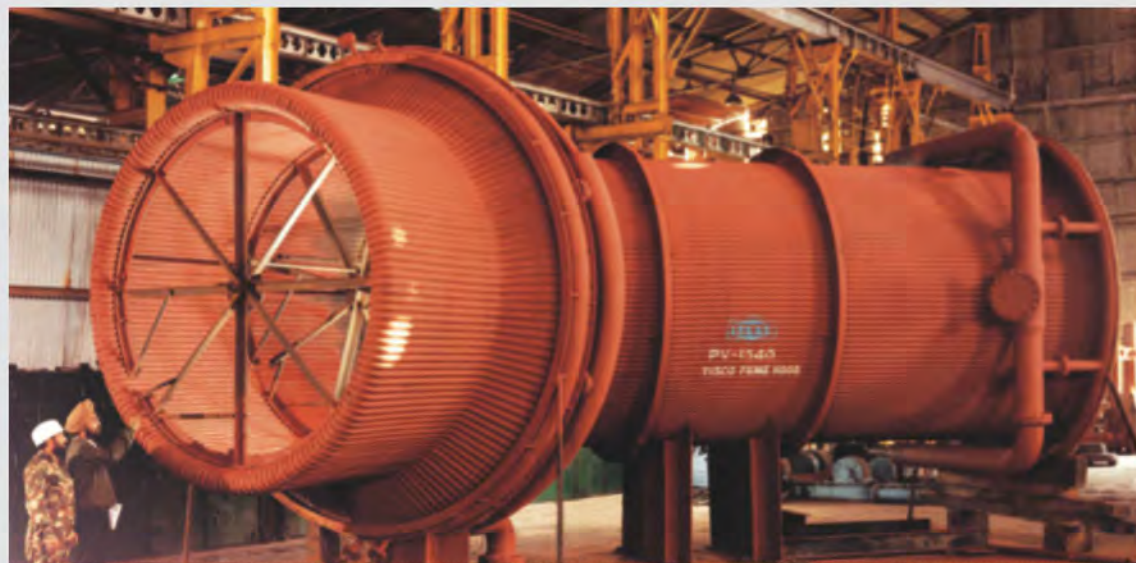
Cette hotte est une partie de l'usine d'épuration de gaz pour un haut fourneau. Nous avons fourni les hottes selon les modèles de Clecim, France et Davy Ashmore, Royaume Uni et elles ont été installées dans toutes les grandes usines d'acier en Inde. Nous avons fabriqué à la fois des hottes de type tubulaire et plan.
