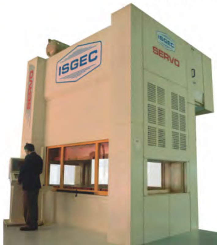
>>> Presse de transfert de 2000 tonnes fournie à Brandl, Allemagne avec une grandeur de table de 6100 mm x 2800 mm et 5 stations de transfert automatisées avec une étampe à coussin de 64 tonnes à chaque station
