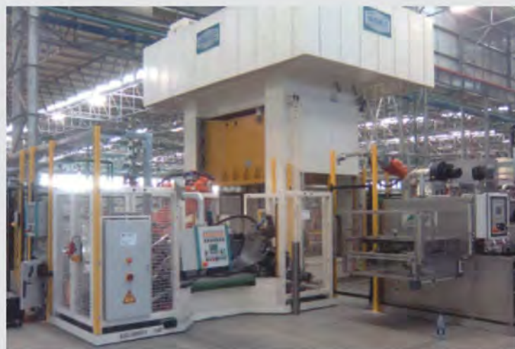
<<< Presse hydraulique de 630 tonnes fournie à Benteler, Afrique du Sud, comprenant des presses hydrauliques personnalisées reliées par automatisation robotisée.
