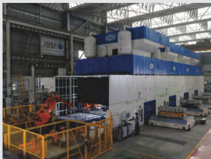
<<< 12-8-8 Presse en tandem automatisée Ligne avec une enceinte étanche à la poussière/son fourni à JBM Group à leur centrale en Inde. La ligne de presse est équipée d'une automatisation robotisée et est utilisée pour produire l'élément de carrosserie pour Suzuki Maruti.
