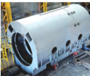
Boîtier statorique pour Centrale Électrique de 250 MW pour BHEL, Haridwar, Inde.
