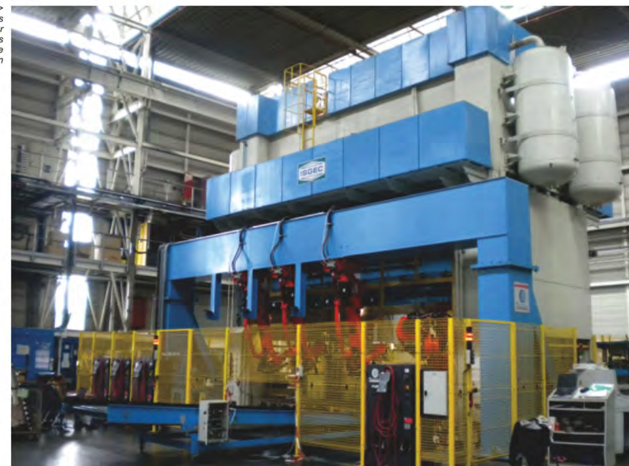
>>> Presse de transfert de 2000 tonnes fournie à Brandl, Allemagne avec une grandeur de table de 6100 mm x 2800 mm et 5 stations de transfert automatisées avec une étampe à coussin de 64 tonnes à chaque station
