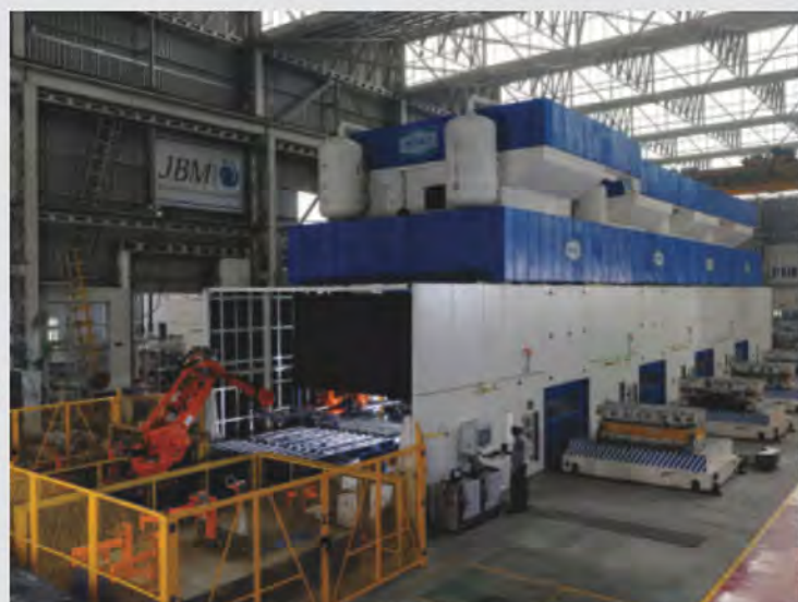
<<< 12-8-8-8 Presse en tandem automatisée Ligne avec une enceinte étanche à la poussière/son fourni à JBM Group à leur centrale en Inde. La ligne de presse est équipée d'une automatisation robotisée et est utilisée pour produire l'élément de carrosserie pour Suzuki Maruti.
