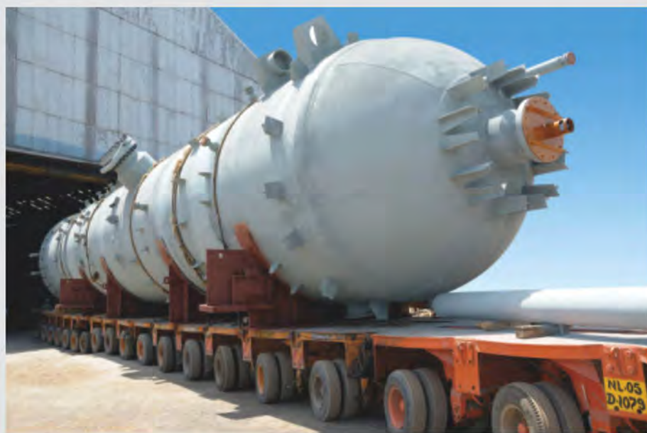
2¼ Cr-1 Mo séparateur chaud pour HMEL, la raffinerie Bhatinda, en Inde.
