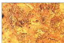
Microstructure d'acier inoxydable martensitique ASTM A 743 Gr.CA6NM.
