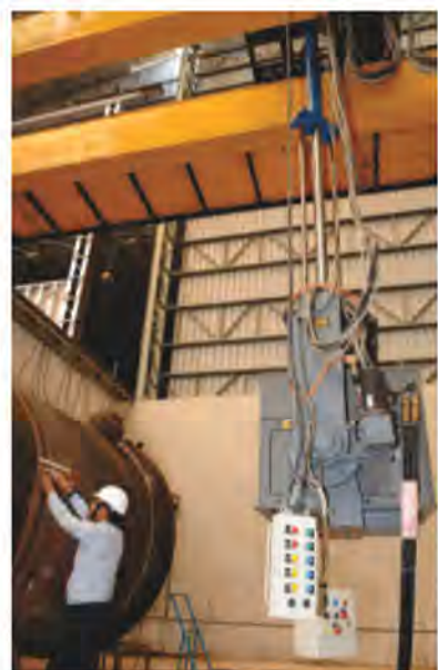
Un dispositif de radiographie de jusqu'à 300 mm (12") d'épaisseur utilisant un accélérateur linéaire de 6MeV. Nous avons 9 salles de radiographie et nous prenons plus de 300,000 radiographies chaque année. Nous avons aussi un dispositif pour la radiographie avec rayons X et avec de l'iridium.
