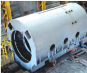
Boîtier statorique pour Centrale Électrique de 250 MW pour BHEL, Haridwar, Inde.
