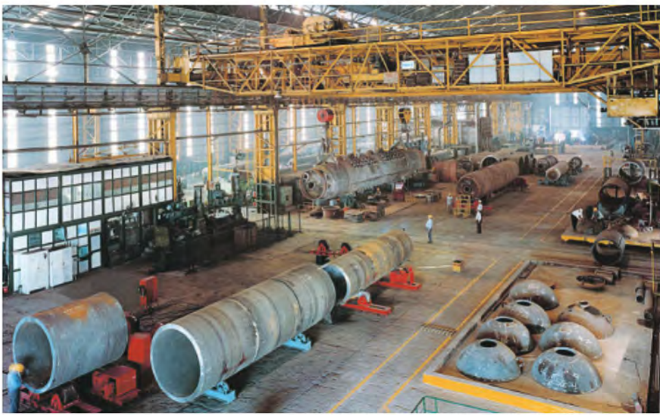
L'une des 7 baies de cuve sous pression Nous avons aussi 14 baies pour la fabrication de pièces sous pression de chaudière.
