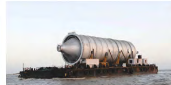
Fours à coke fournis à MRPL pour leur établissement DCU par Punj Lloyd. 4 types de tels fours à coke plaqués ont été fournis ayant un diamètre de 9144 mm, une longueur de 41 600 mm et pesant 454 tonnes chacun.
