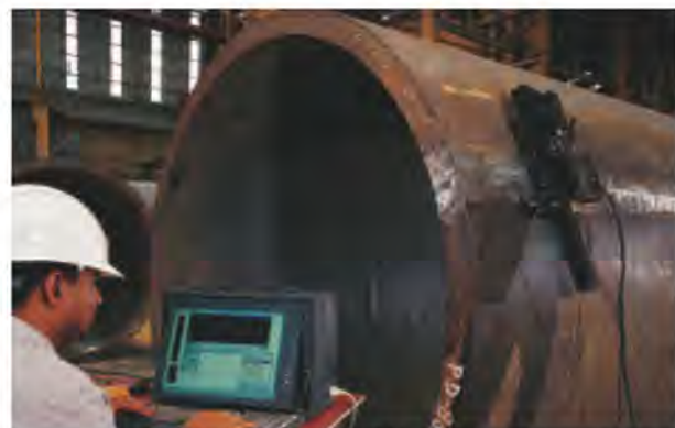
Ultrasons mécanisée de 100 mm (4") d'épaisseur tambour.
