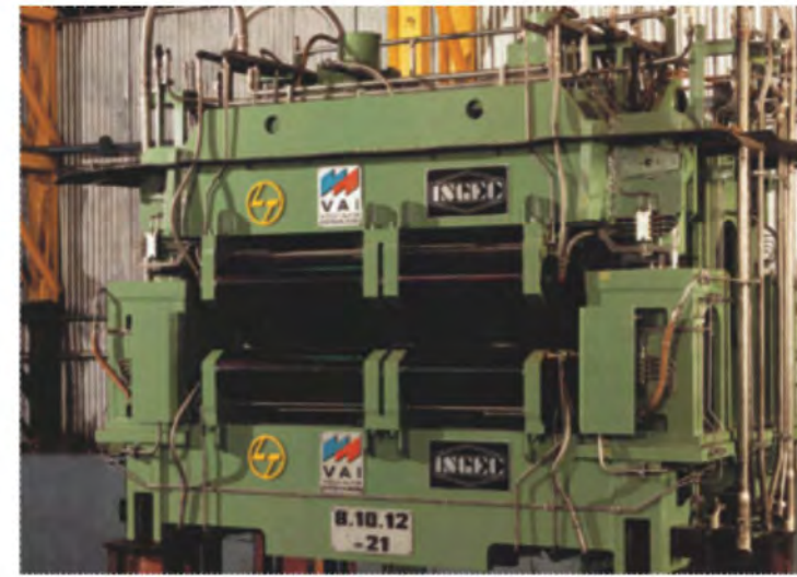
Le Segment de Guidage de Barre montré dans cette image est une partie d'une Usine de Coulée Continue. Nous avons fourni des Équipements Mécaniques pour CCP à la conception de SMS-Demag, Allemagne et Voest Alpine, Autriche
