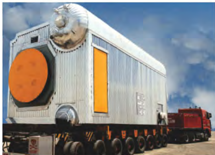
Chaudière autonome de 77 TPH étant expédiée pour installation à Longview, Maudsville, West Virginia, États-Unis.
