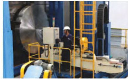
Perceuse pistolet pour le forage des tôles pour les tubes jusqu'à une épaisseur de 1000 mm.
