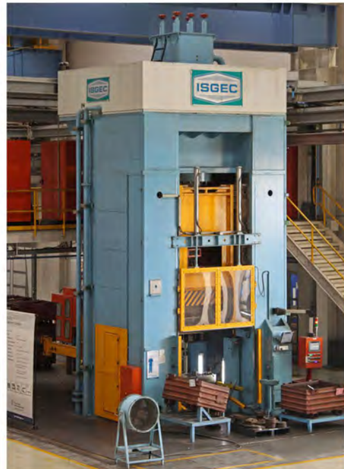
16000 kN 液圧プレスは、Hirschvogel グループのインド・ブネ工場に納入致しました。こちらのプレス機は、自動車で使用される冷間鍛造トランスミッションコンポーネントを製造のために使用されます。
