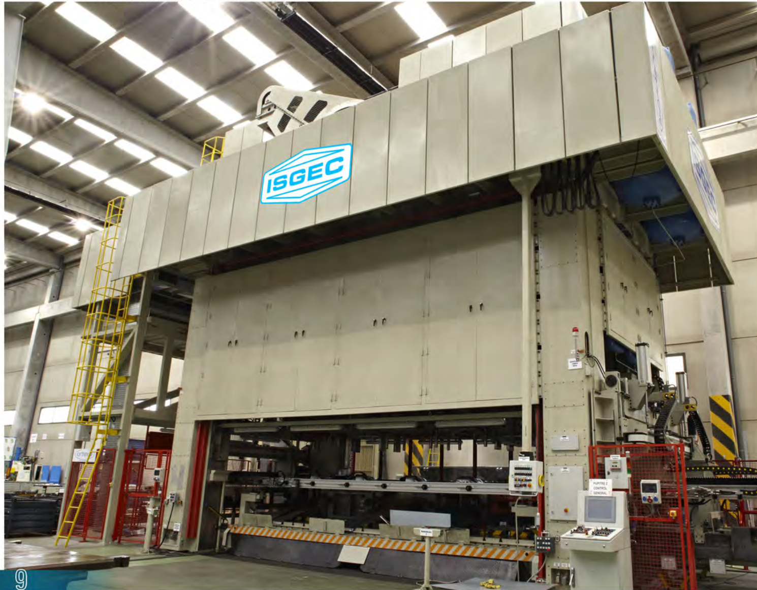
そしてスペインビルバオ、エガナCIEオートモーティブ社にBolsterサイズ7000 mm x 2750 mm、3軸電子サーボ搬送システム、コイル送りライン組み込みの25000 kN トランスファープレス機を納入致しました。こちらのプレス機は2009年にゼネラルモーターズ (GM) に部品製造用納入致しました。
