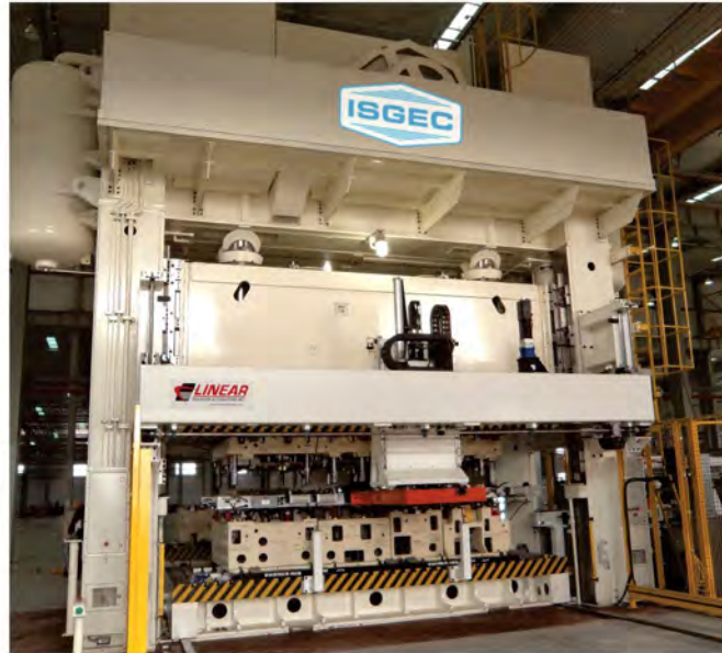
車両座席製造会社の中国工場に12000 kN トランスファープレス機を納入致しました。ボルスタサイズ5500 mm x 2500 mm で、3軸電子サーボトランスファーシステムと Destackerが搭載されています。
