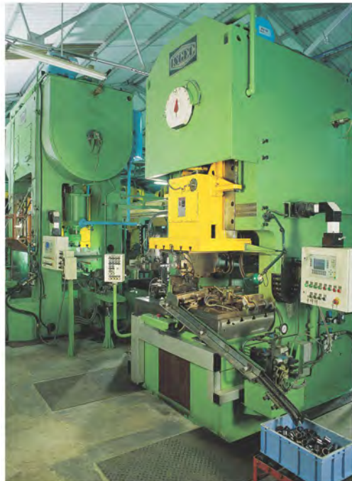
こちらのバイメタルエンジンベアリング製造用自動生産ラインは6ステーションで自動運送によって1分あたり最大80個を製造致します。日本Diadoのライセンスであるバイメタルベアリング (Bi-Metal Bearings) に納入致しました。
