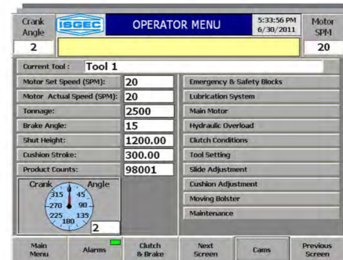
Isgecはプレスシステムの制御向け専用ソフトウェアを開発致しました。ユーザーフレンドリーなソフトウェアはインスタント診断に使用されます。この画像は、メインメニューのタッチスクリーンです。
