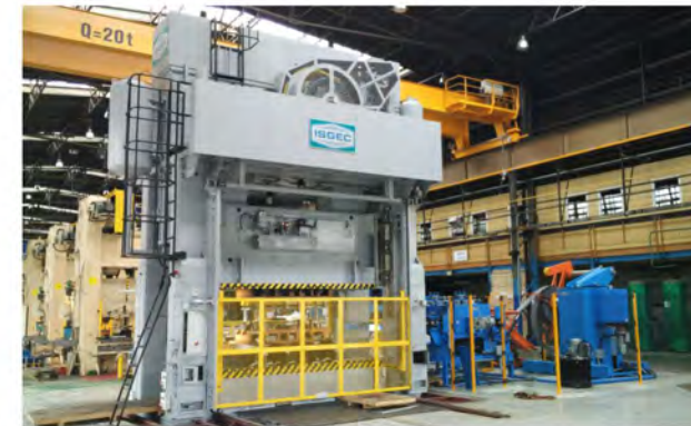
Comaco グループのポーランド工場に6300 kN プログレッシブダイメカニカルプレス機を納入致しました。プレス機は、ベッドサイズが3700 x 1600 mmで、スライドストロークが400 mm、運転速度が22-44 spmです。メキシコとブラジルの工場にも同様なプレス機を納入したことがあります。
