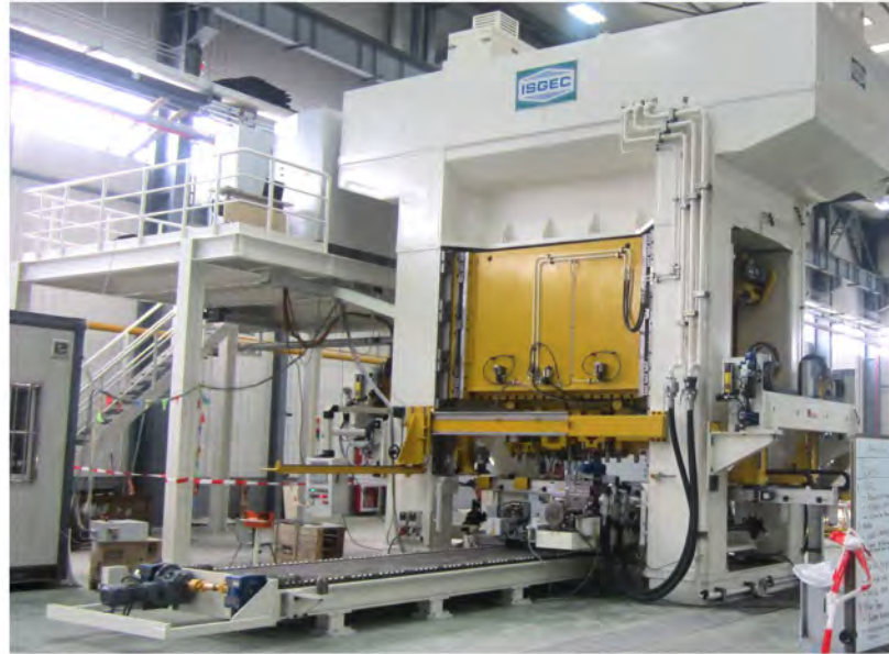
中国のBenteler グループの上海工場に平行制御システム組み込みの8000kN 液圧トランスファープレス機を
