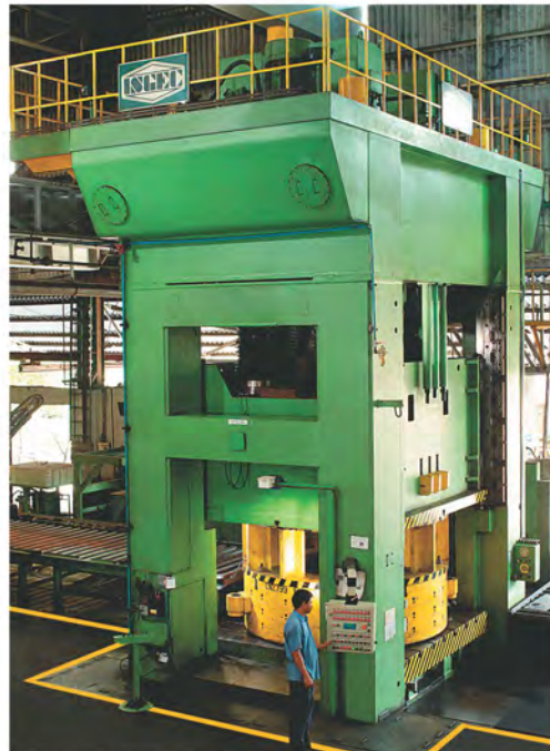
TVSグループのWheels India社に納入したベッドサイズ3000mm x 3000mm、20000 kN 液圧プレス機がキャタピラー (Caterpillar) と小松 (Komatsu) の地球の発動機機械車輪の加熱成形向け使用されます。
