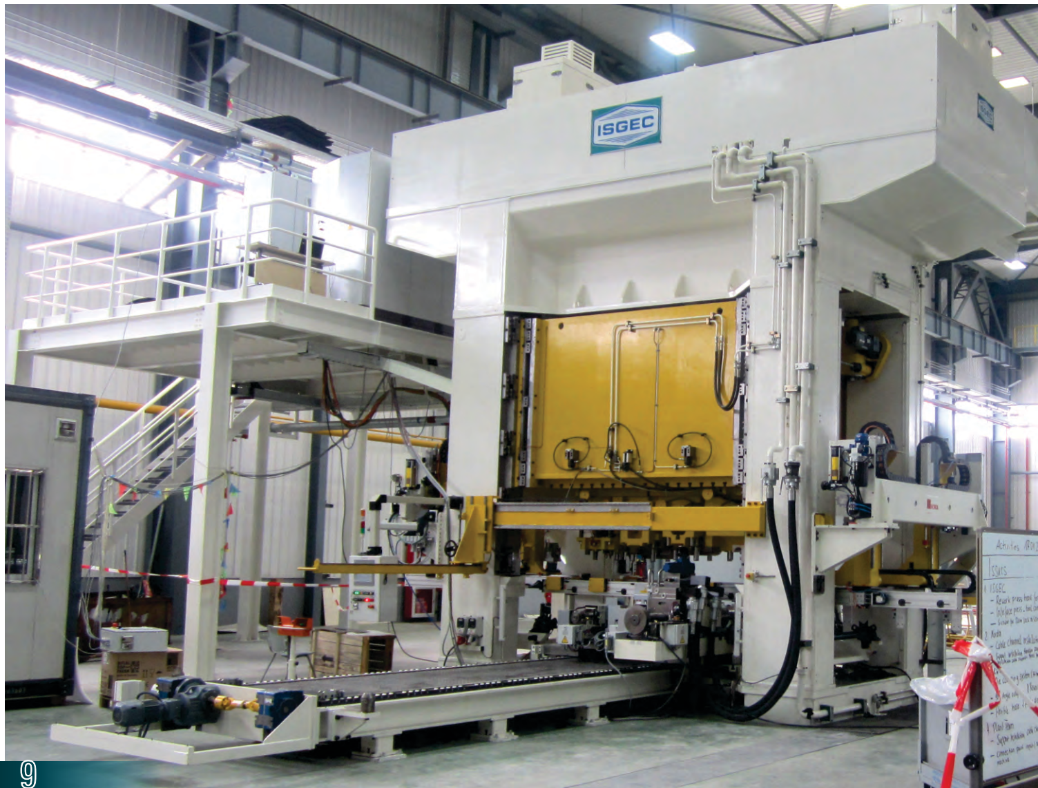
中国のBenteler グループの上海工場に平行性制御システム組み込みの8000kn 液圧トランスファープレス機を
