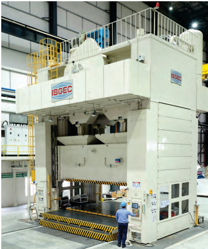
日本の多国籍企業に供給された1500T機械式トライアウトプレス。 タタモーター、マヒンドラグループ、ヒロテック、ユニプレスへも、類似したプレス機を最 大2000Tまで供給しています。
