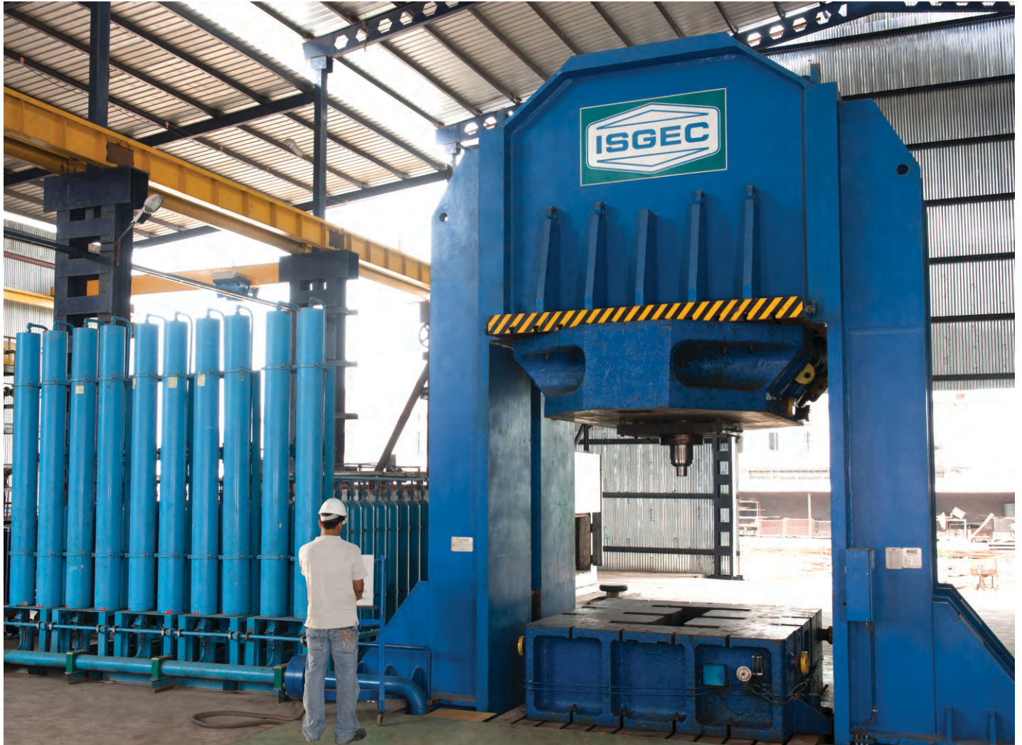
こちらの125000 kN 液圧プレス大型アキュムレータバンクは、防衛及び航空宇宙アプリケーション用高張力鋼板の加熱・冷間成形に使用されます。
