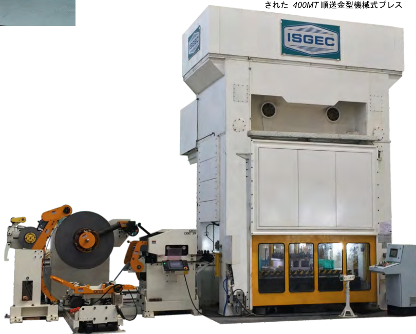
インドの大手ティア1自動車メーカーに供給された400MT順送金型機械式プレス
