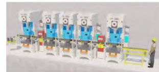
C型プレスライン用の2軸モノバー搬送システム
