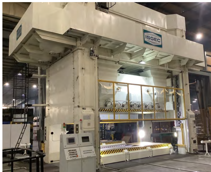
米国の自動車シートメーカーのメキシコ工場に供給された1500T機械式トランスファープレス
