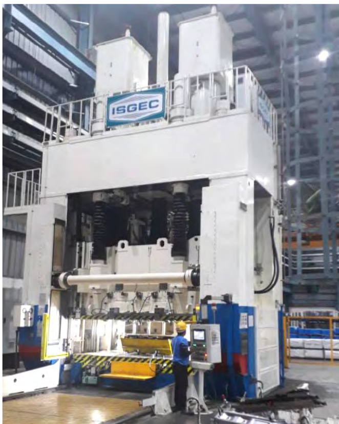
1200Tトライアウトプレスと180度スライド傾斜機能を備えた 300Tダイスポッティングプレスの組み合わせ
