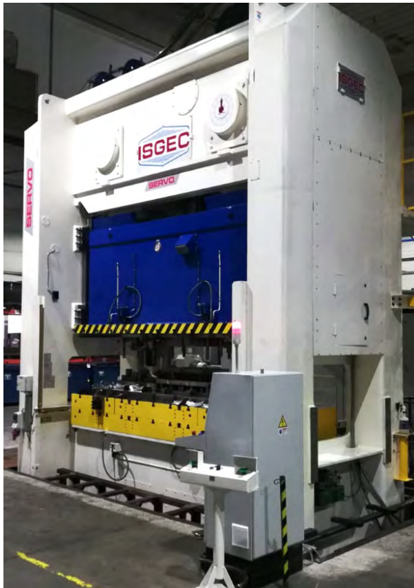
ハンガリーの顧客に供給された630Tと400Tの ストレートサイドサーボ機械式プレス
