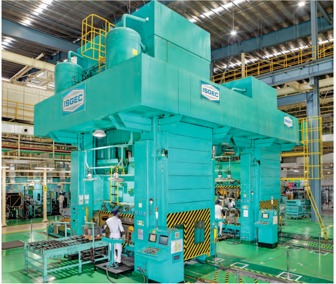
日本企業の委託による、インドの二輪部品製造工場に供給された630Tリンクドライブと400T偏心ギアドライブのタンデムライン
