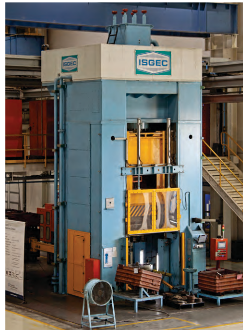
インドで納入された、冷間鍛造の自動車トランスミッション部品製造用の1600T液圧プレス
