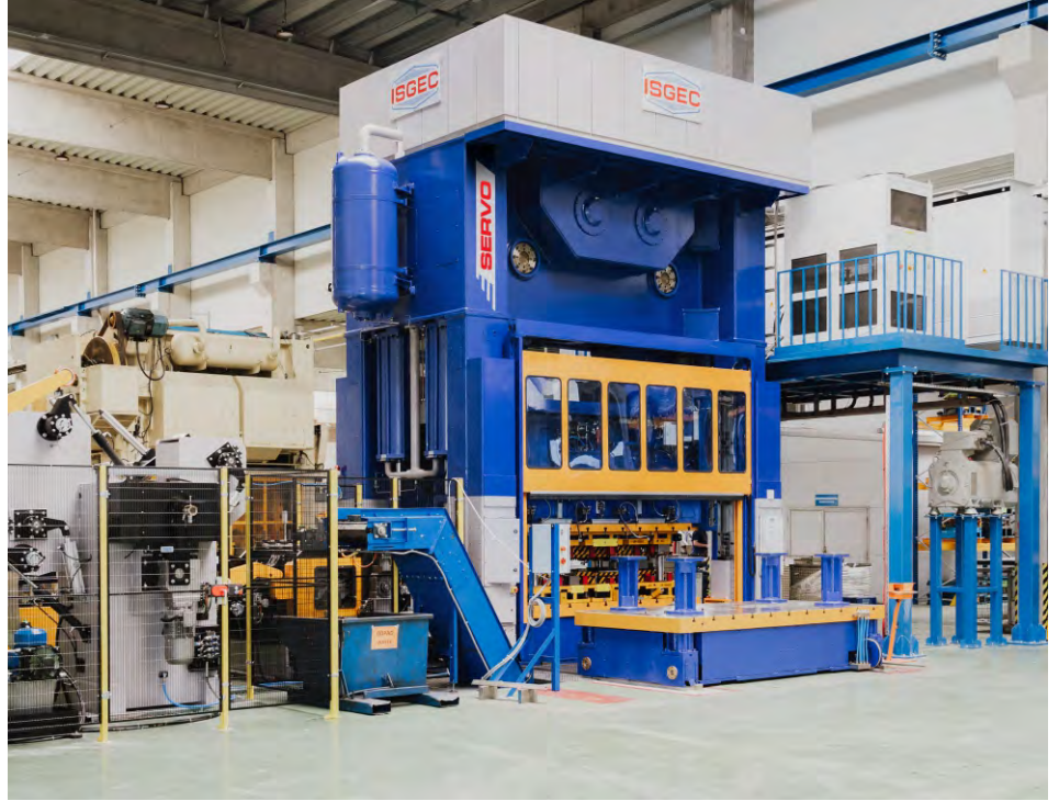
スロバキアで設置された、順送対応のボルスターサイズ3400 mm x 1600 mm、 3-50 spmの630Tサーボ機械式プレス
