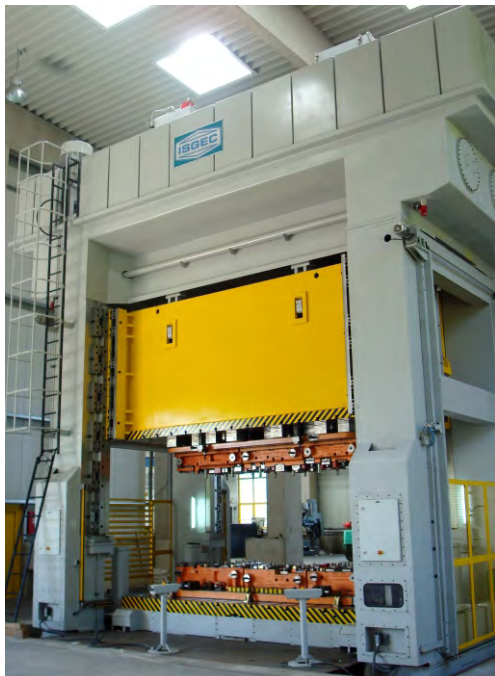
大手自動車メーカーの主要部品のテストおよび製造用として、ドイツで供給された1200T液圧プレス。このプレス機は4500 mm x 2200 mmの可動式ポルスターとダンパー設置対応を備えており、ブランピングにも適しています。
