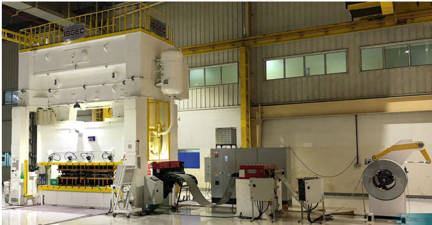
インドの日本企業委託工場に設置された、ヘッドサイズ4000 mm x 1500 mmの400T順送金型機械式プレス
