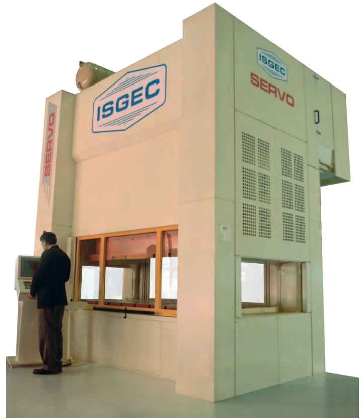
ルーマニアの顧客に供給されたボルスターサイズ2800 mm x 1100 mm、 3-60 spmの400Tサーボ機械式プレス
