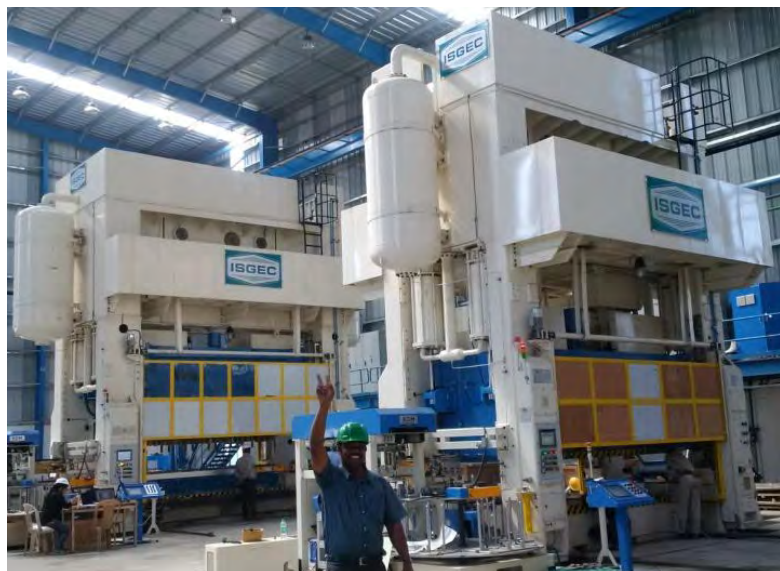
インド・バンガロールのティア 1 自動車会社に供給された、ボルスターサイズ4300 mm x 1400 mmの1250Tトランスファープレスおよび、韓国のトランスファーシステムを備え付けた、ボルスターサイズ3700 mm x 1400 mmの630Tプレス。ここからほとんどの4輪・2輪の委託工場への供給実績がある。
