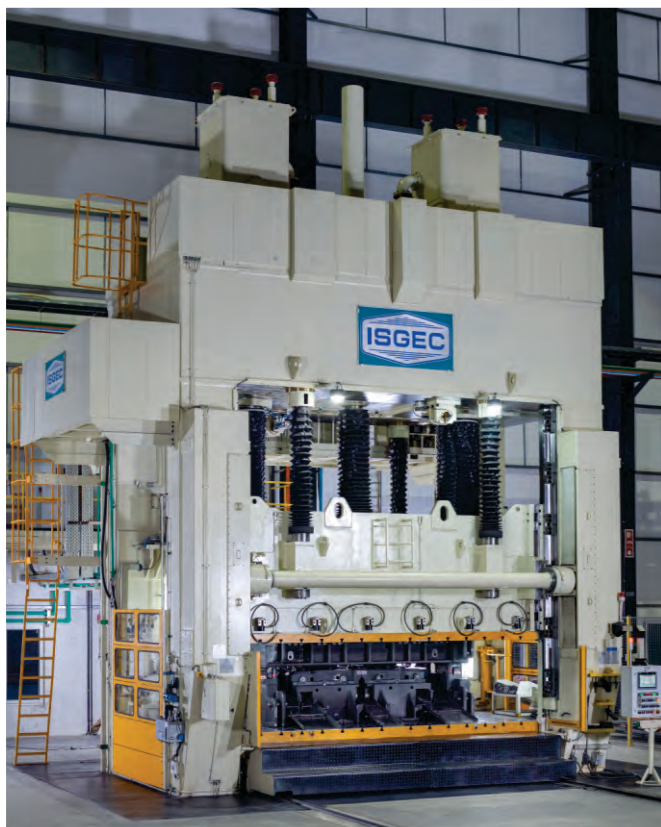
日本のスタンピング金型製造企業のインド工場に供給された1000Tトライアウトプレスと 300Tダイスポッティングプレスの組み合わせ
