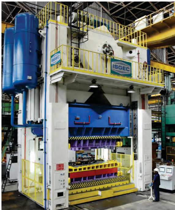
タタモーターに供給された、最大限微動調整機能を備えた 2000T機械式トライアウトプレス
