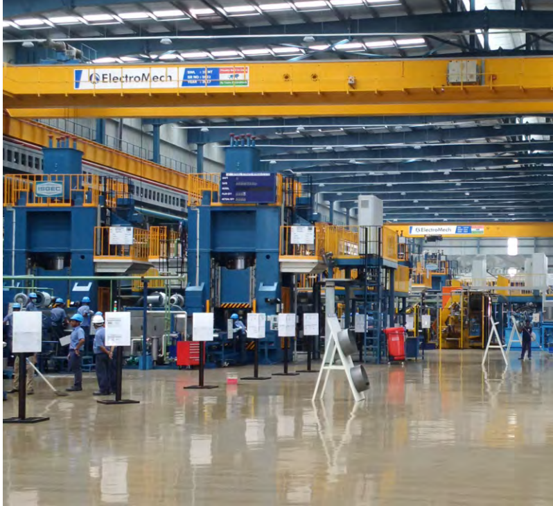
インドの大手ティア1自動車サプライヤーに供給された、 車輪製造用の液圧プレス群
