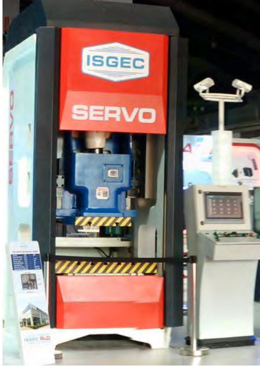
110T リングフレーム サーボ機械式プレス
