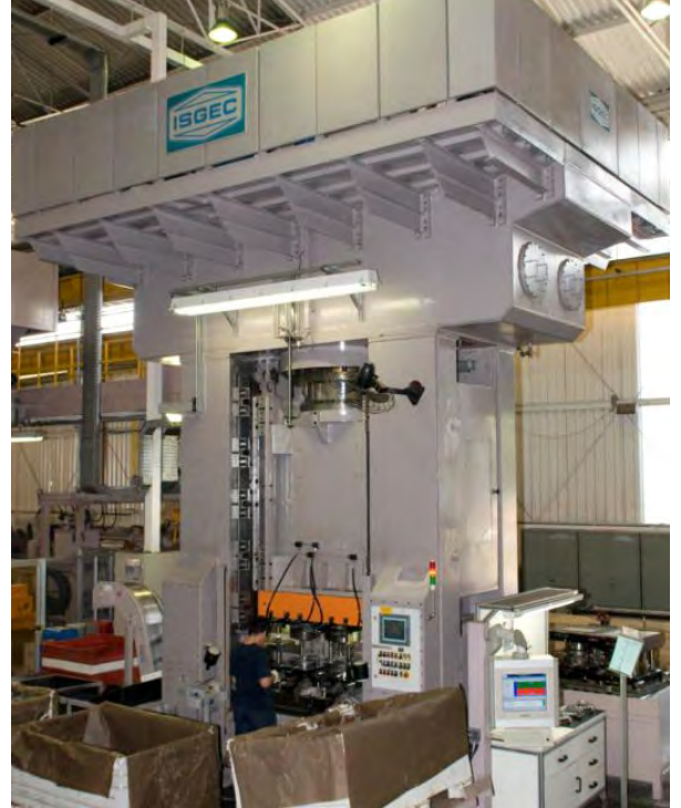
ドイツの多国籍企業のブラジル工場に供給された、クラッチ部 品製造用の1500T高速液圧式プレス。同社の南アフリカ工場・ インド工場にもほぼ同型の発注をいただきました。
