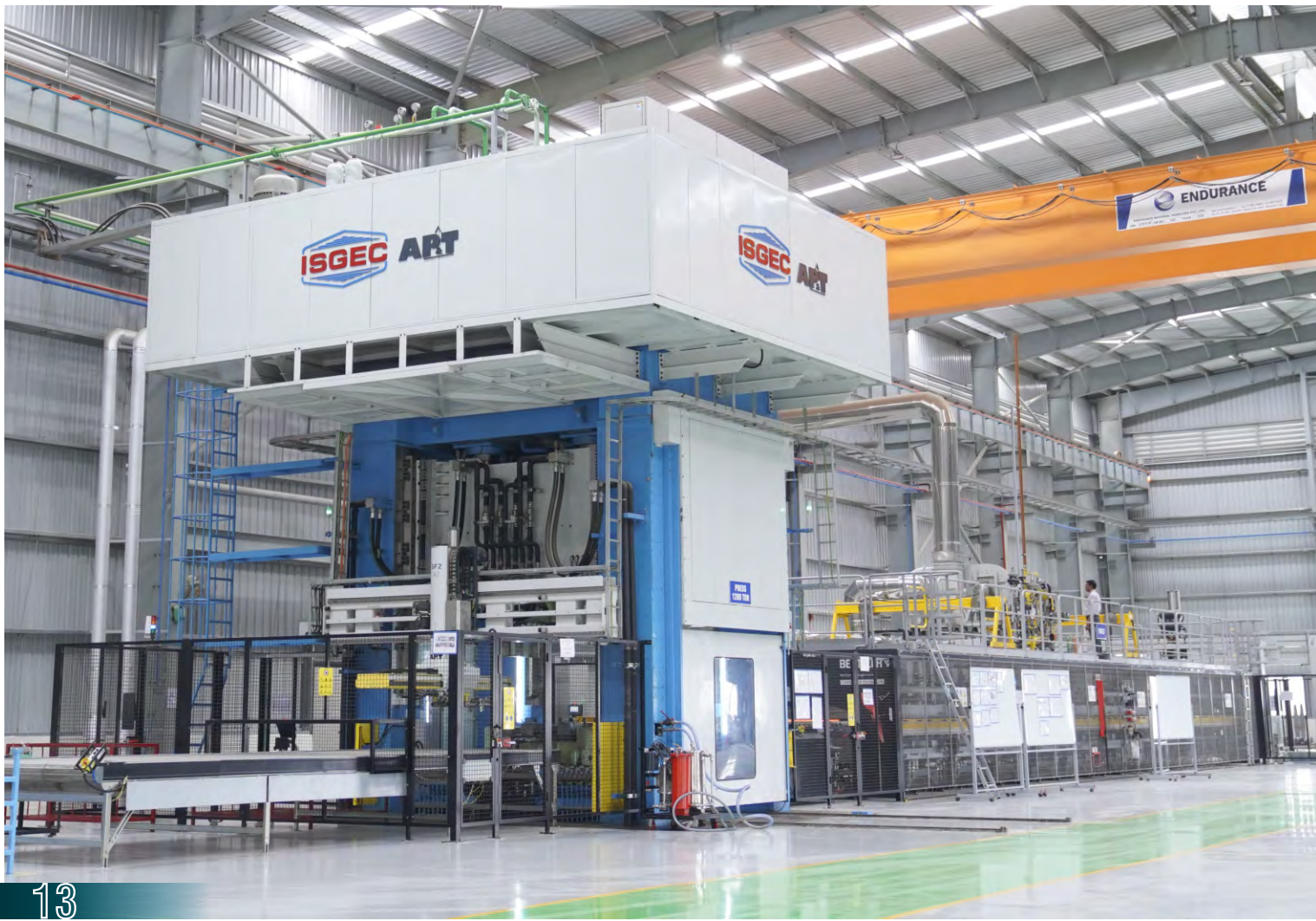
インドのティア1自動車サプライヤー使用の1200T液圧熱間成形プレス
